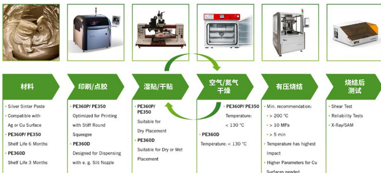
图4: 不同烧结银产品的工艺流程，包括湿贴或干贴。
